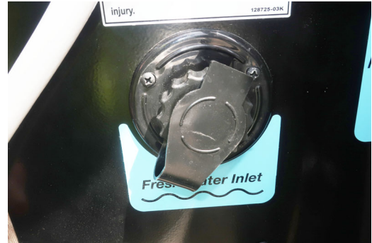
Tank Fill Inlet
